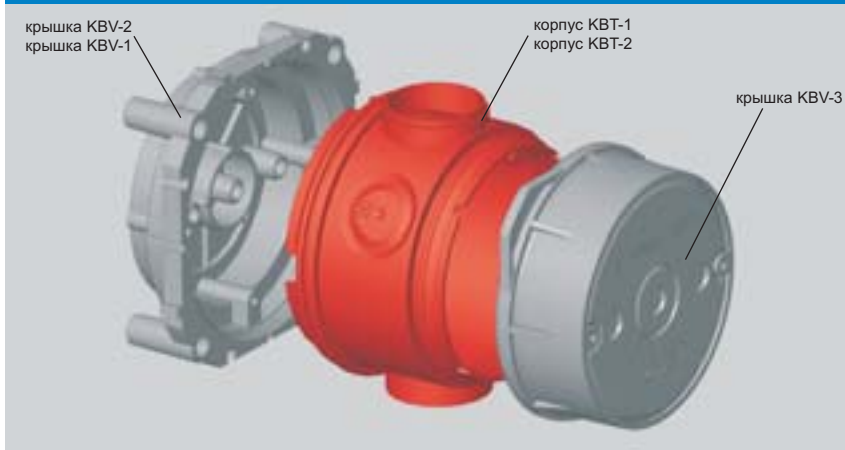
Рис. 5 Пример установки крышки KBV-3
