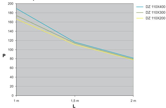
На графике указана максимальная допустимая равномерно распределенная нагрузка лотков в зависимости от расстояния между опорами.
