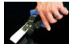
**L-42W** - ножницы для кабель-каналов и пластмассовых труб
