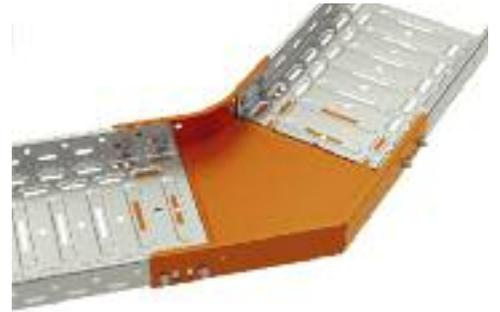
Для создания горизонтального изгиба трассы, можно использовать также соединитель NSUK. Он позволяет создать горизонтальный изгиб трассы по желанию заказчика под требуемым углом. Соединитель изгибается и прикручивается к лоткам с помощью болтов.
