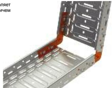
Построение горизонтального ответвления с использованием редуционных частей. Это решение позволяет при необходимости уменьшить ширину трассы. Сначала удаляется часть боковой части с основного широкого лотка, затем таким же образом удаляются боковины у более узкого ответвляющего лотка, далее с помощью болтов крепятся две редуционные половины на ширину ответвления.
