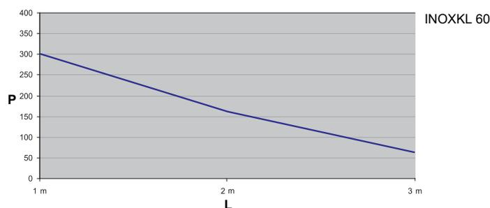
На графике показана максимально допустимая равномерно распределенная нагрузка лотка в зависимости от расстояния между опорами.
